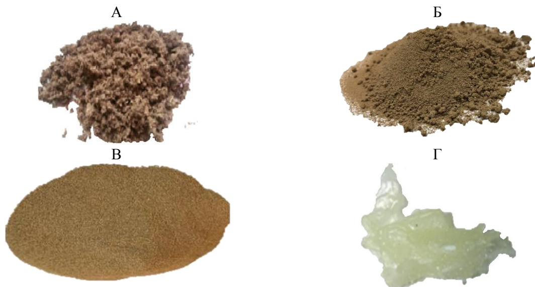
Рисунок 4 – Биосорбенты (носители с иммобилизованным альго-бактериально-дрожжевым консорциумом): А: Обезвоженный осадок активного ила; Б: Глауконитовый минерал ( Биогеосорбент ГЕОЛЕКС® ); В: Аргиллитовый минерал; Г: Катионный полиакриламид.
